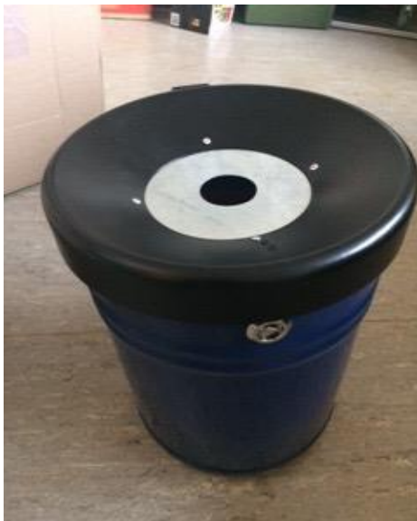
Abb.5: Neuer Entsorgungsbehälter, in der Werkstatt umgebaut
